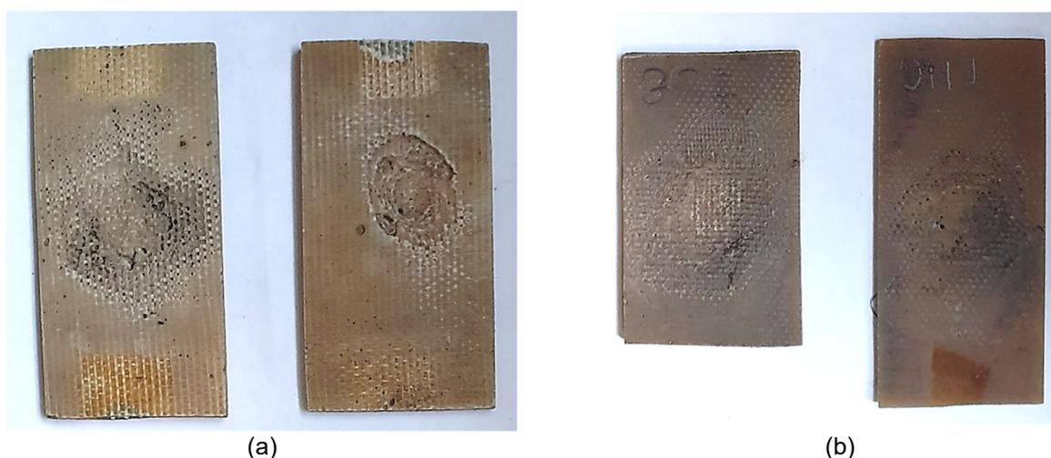
**Рис. 5 - Фото образцов стеклопластиков на связующем ЭС после испытаний на газообразивный износ при комнатной температуре на экспериментальном стенде: а) на стеклоткани Т23; б) на стеклоткани ЭЗ200**
