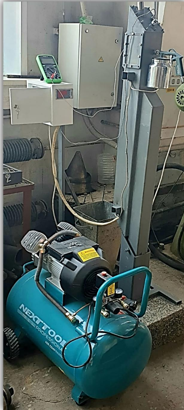
**Рис. 2 - Изготовленный стенд для испытаний на газоабразивный износ**
