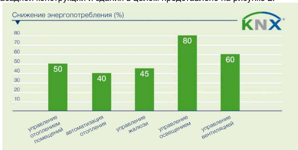
**Рис. 2 - Снижение энергопотребления здания с интеллектуальным управлением фасадных конструкций**
