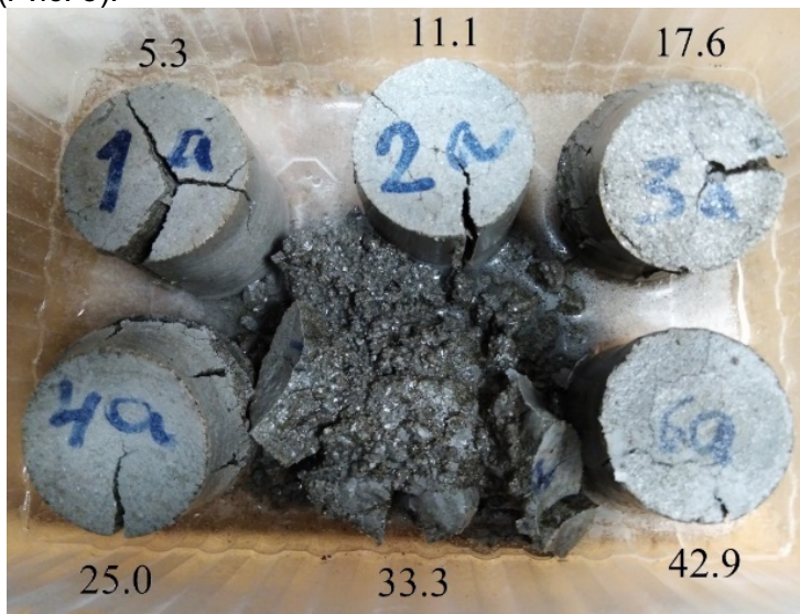
Рис. 5 - Образцы из зольного теста с содержанием добавки микрокремнезема от 5,3 до 42,9 % от массы золы через 11 суток воздушного твердения и 2 суток пребывания в воде
