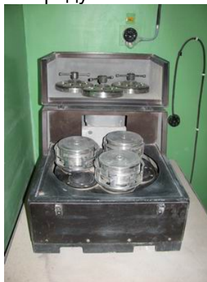
Рисунок 1 – Лабораторная планетарная мельница МПЛ-1
