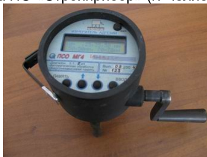
Рисунок 2 – Измеритель адгезии ПСО-5-МГ4
