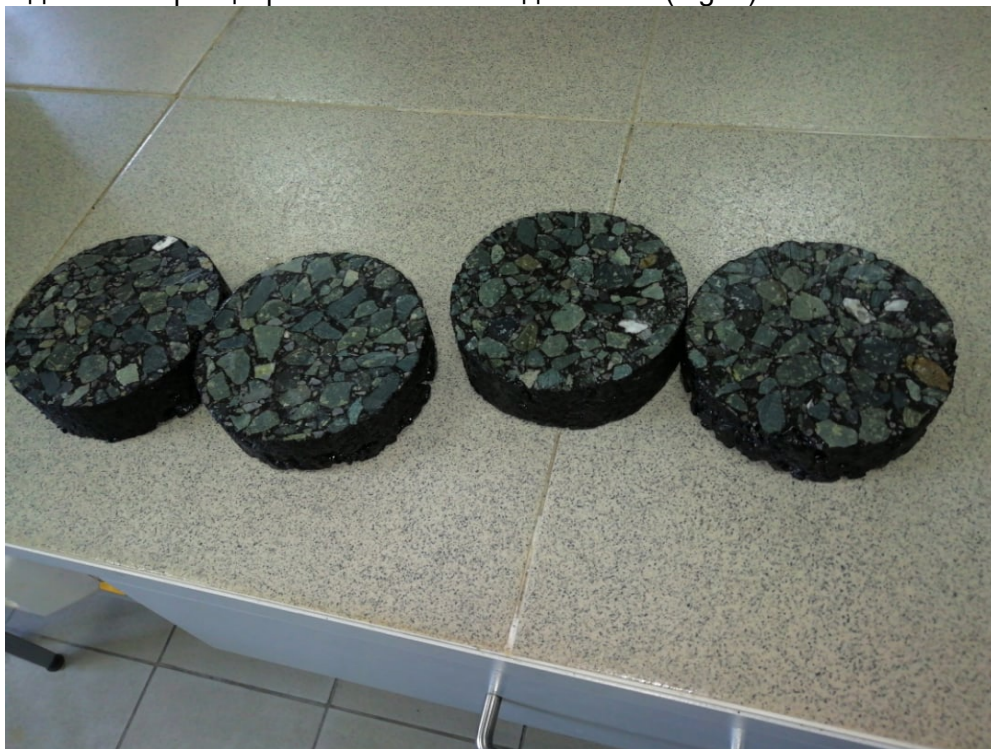
Рис. 1 – Испытуемые образцы асфальтобетона
