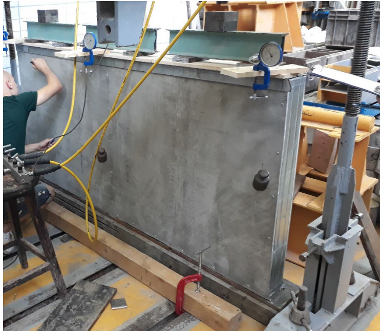
Рис. 2 – Стеновая ограждающая панель перед испытанием на прочность Fig. 2 – Wall enclosure panel before strength test
