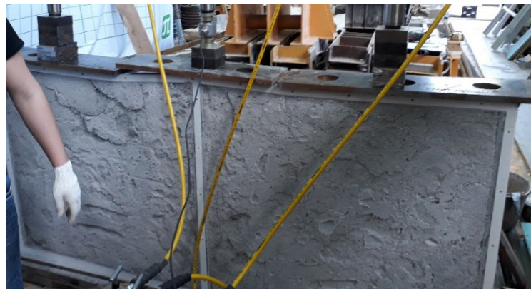
Рис. 6 – Внешний вид конструкции после потери несущей способности: (а) - до вскрытия облицовки; (б) – деформации в пенобетоне.
