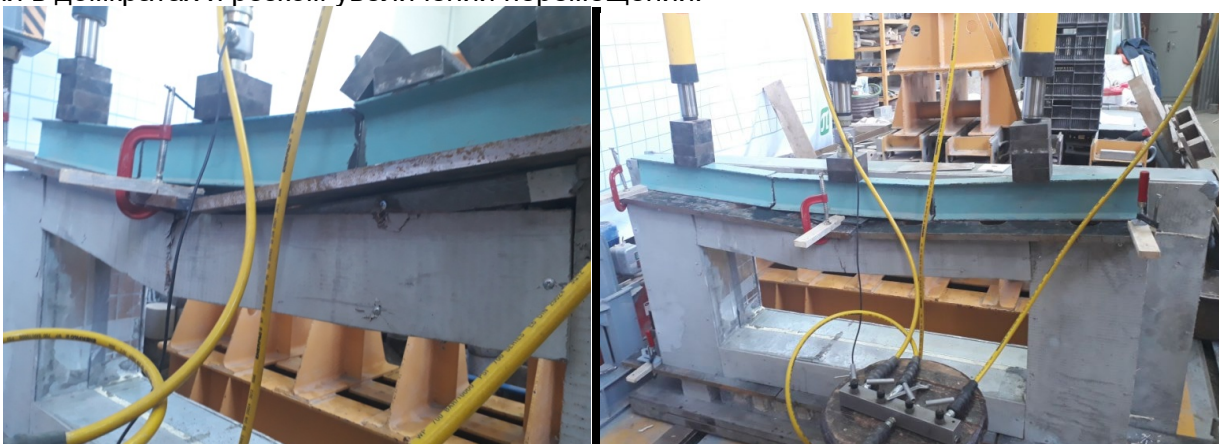
Рис. 9 – Образец в момент потери несущей способности Fig. 9 – Sample at the moment of the bearing capacity loss
