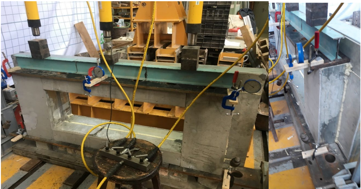
Рис. 4 – Стеновая ограждающая панель с оконным проемом перед испытанием Fig. 4 – Wall enclosure panel with the window opening before strength test
