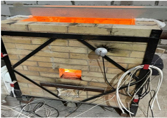
Рис. 6 - Печь для проведения маломасштабного испытания Fig. 6 - Furnace for small-scale testing
