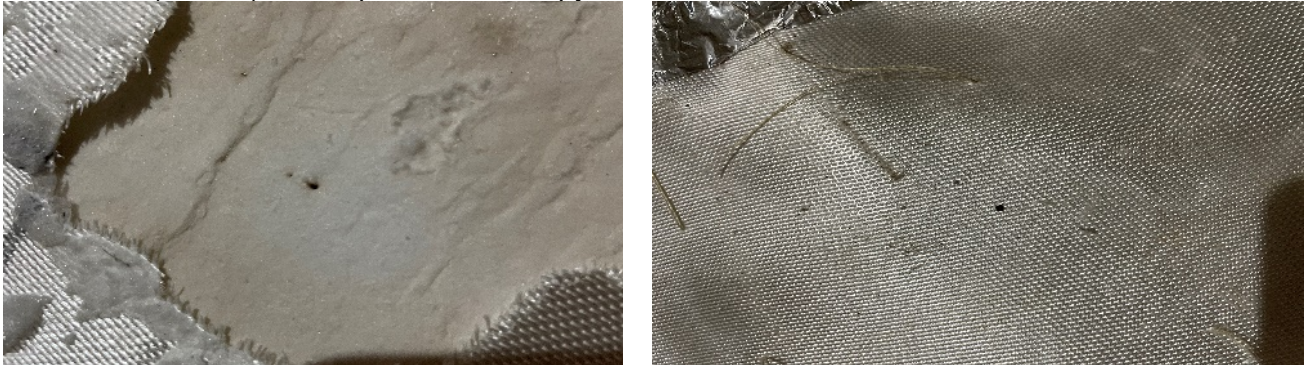
Рис. 11 - Появление пробоев на образце № 7 при проведении огневого испытания Fig. 11 - Appearance of breakdowns on Sample No. 7 during the fire test
