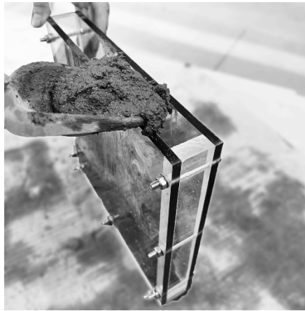
Рис. 5 - Бетонирование образца в опалубке из оргстекла
