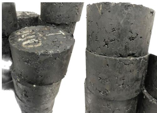
**Рис. 5 – Образцы, сформованные из гранул до монолитного состояния (изображение выполнено автором статьи)**
