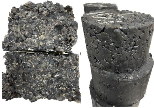
**Рис. 6— Внешняя и внутренняя поверхность образцов, сформованных из отдельных гранул (изображение выполнено автором статьи)**
