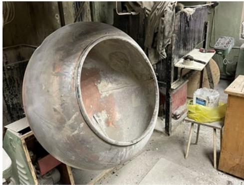
**Рис. 2 – Гранулятор промышленный тарельчатого типа (изображение выполнено автором статьи)**
