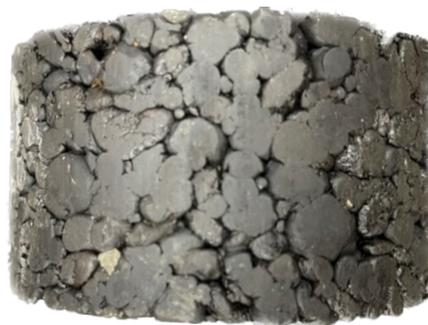
**Рис. 4 – Пример образца, сформованного из гранул (изображение выполнено автором статьи)**
