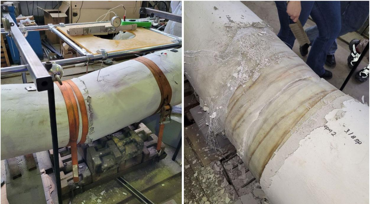
**Рис. 15 – Общий вид разрушения опытного образца оболочки (слева – непосредственно после разрушения, справа – после снятия слоя шпаклевки)**
