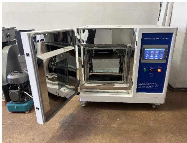
Рис. 2 – Климатическая установка и образец Изображение выполнено автором статьи Fig. 2 – Climate control unit and sample Image by the author of the article
