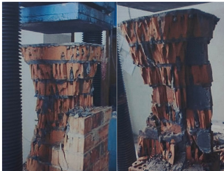
Рис. 6 – Опытный образец в стадии разборки после испытания – «клин» в верхней приопорной зоне [15] Fig. 6 – The prototype in the disassembly stage after the test is a – "wedge" in the upper support zone [15]
