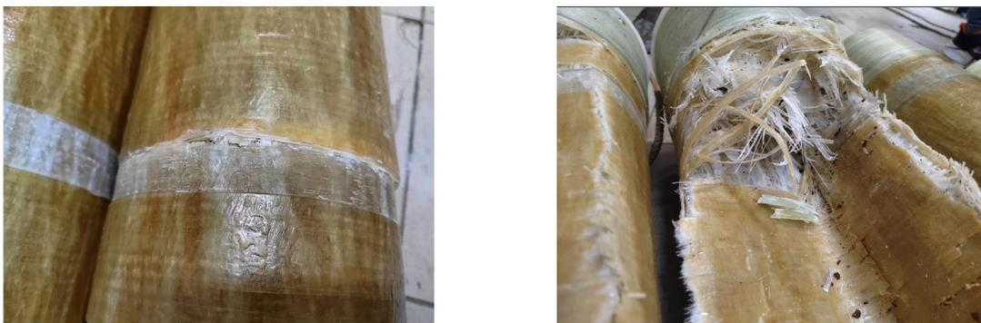
Рис. 2 - Фотографии разрушений гибридных стеклобазальтопластиковых труб
