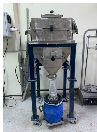
Рис. 1 – Лабораторные шаровые мельницы (объемом: а – 5 л, б - 20 л)
