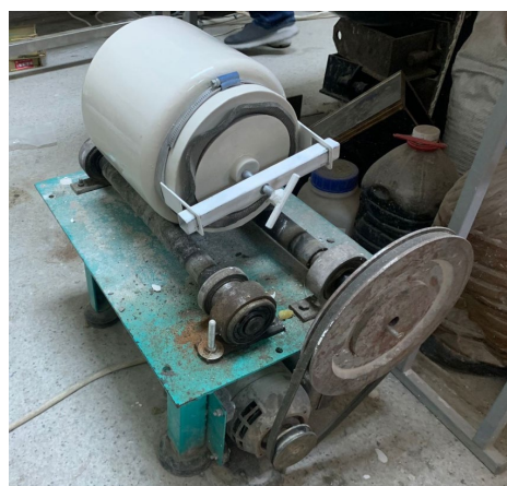
Рис. 1 – Лабораторные шаровые мельницы (объемом: а – 5 л, б - 20 л)
