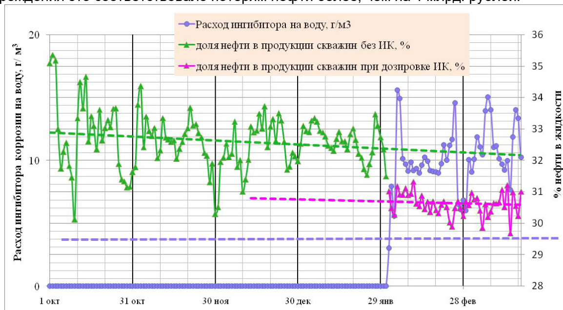
Рис. 2 – Динамика изменения содержания нефти в продукции скважин до (зеленая кривая) и после начала использования ИК (Сонкор-9011) с расходом 10-15 мг/л воды. Пунктирные линии – компьютерная аппроксимация представленной динамики
