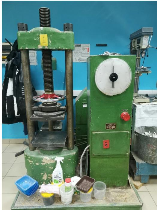
**Рис. 6 - Общий вид гидравлического пресса**
