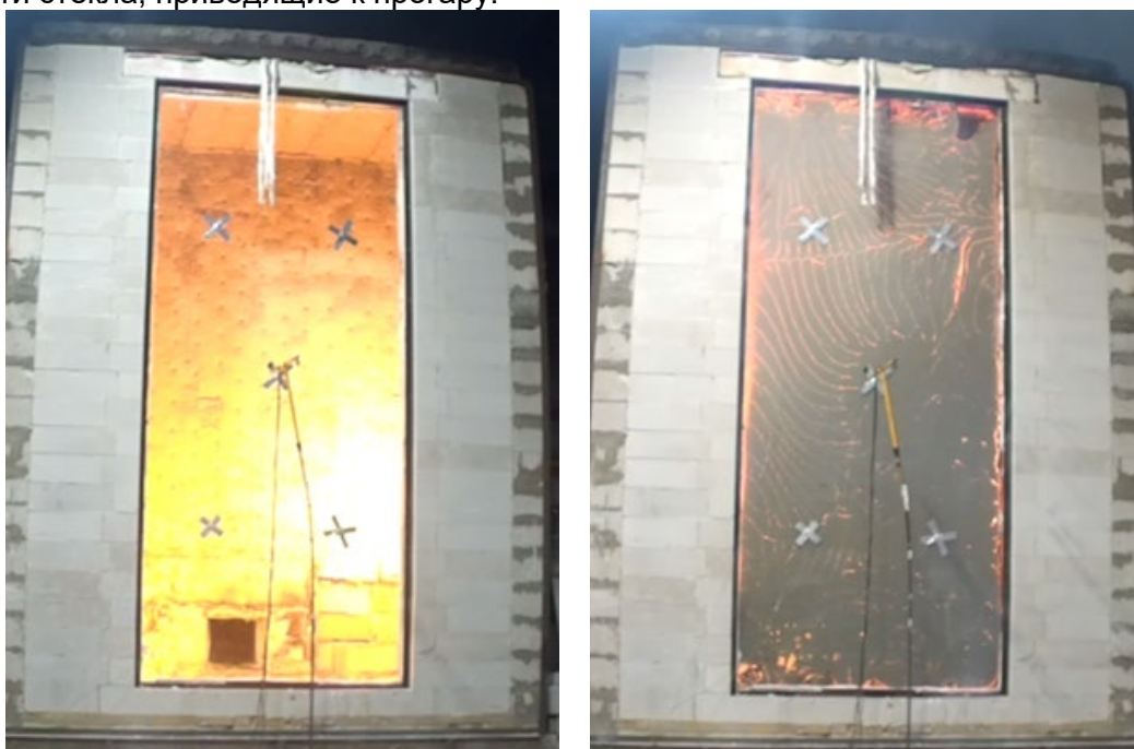
Рис. 10 – Образец №2.1 на 5 минуте (слева) и 15 минуте (справа) испытаний Изображение выполнено автором статьи
