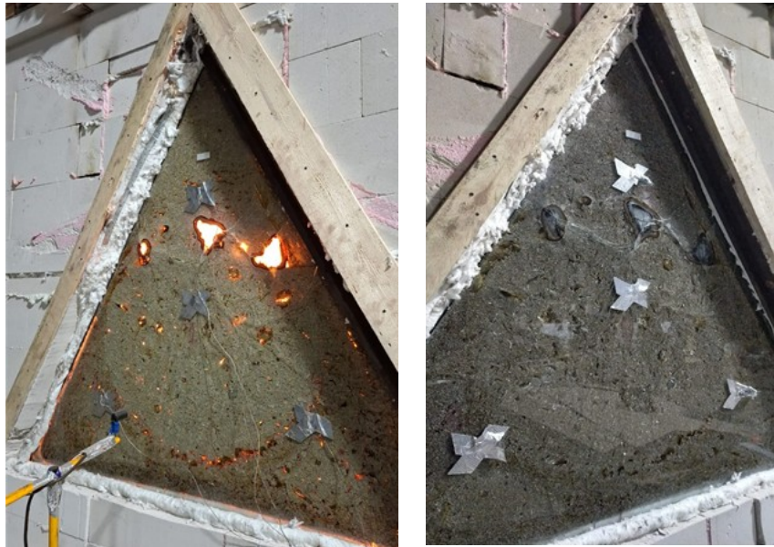
Рис. 7 – Образец №1.3 во время (слева) и после (справа) испытаний Изображение выполнено автором статьи Fig. 7 – Sample No. 1.3 during (left in the figure) and after (right in the figure) testing Image by the author of the article
