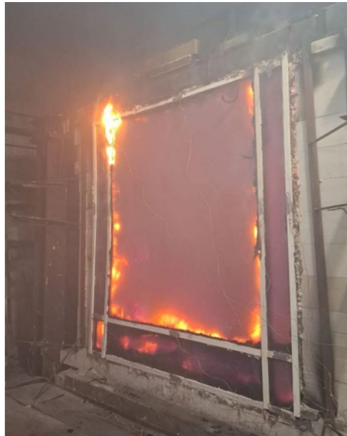
Рис. 3 – Прогар элементов конструкции в результате неправильного монтажа Изображение выполнено автором статьи Fig. 3 – Burnout of structural elements due to improper installation Image by the author of the article
