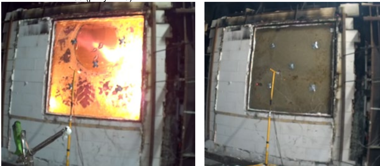
Рис. 9 – Образец №1.5 на 15 минуте (слева) и 57 минуте (справа) испытаний Изображение выполнено автором статьи Fig. 9 – Sample No. 1.5 at 15 minutes (on the left in the figure) and 57 minutes (on the right in the figure) of testing Image by the author of the article
