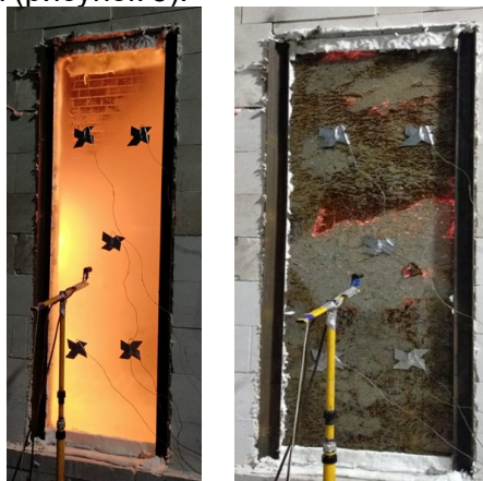
Рис. 5 – Образец №1.1 на 7 минуте (слева) и 24 минуте (справа) испытания
