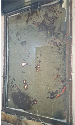
Рис. 2 – Точки прогара стеклопакета, вызванные плохой адгезией геля к стеклу
