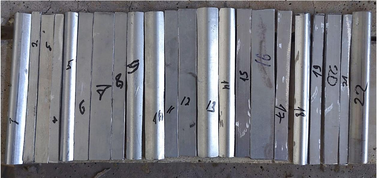
**Рис. 4 – Готовые к испытаниям образцы одной из заготовок**
