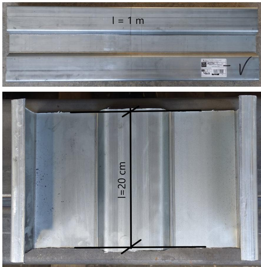
Рис. 2 – Исходный профиль (сверху) и заготовка (снизу)
