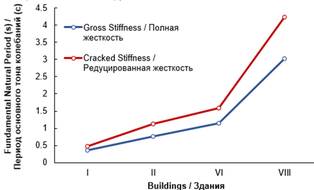
Рис. 16 – Влияние сечений с трещинами Fig. 16 – Effect of cracked stiffness
