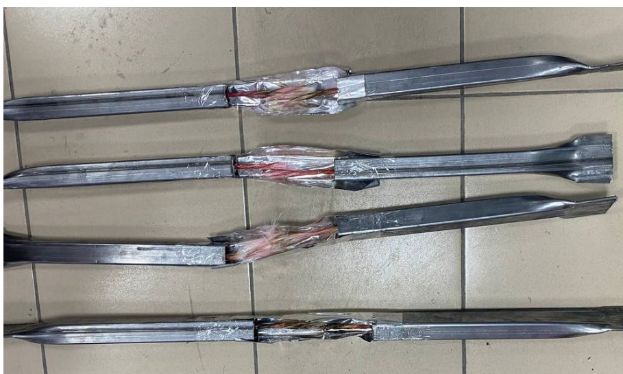
Рис.5 – Образцы после испытания, сверху вниз 100°C, 150°C, 250°C, 300°C Fig.5 – Samples after testing, from top to bottom 100°C, 150°C, 250°C, 300°C
