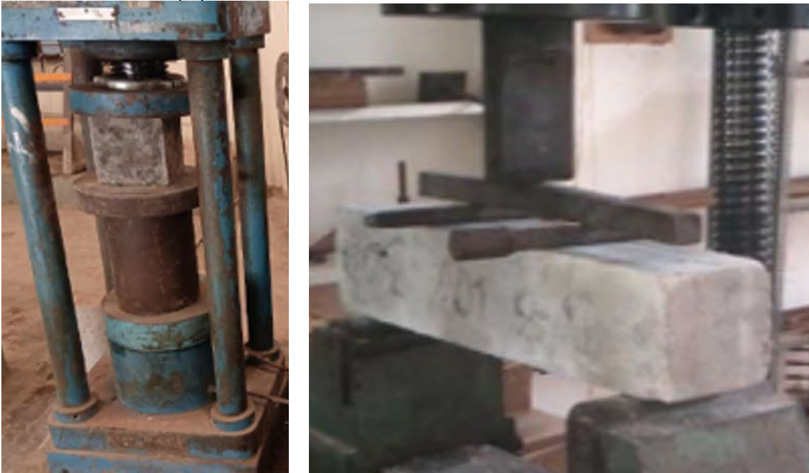
Рис.2 – Испытание геополимеров на прочность: а) при сжатии, б) при изгибе (Иллюстрация выполнена авторами) Fig.2 – Testing of geopolymers for strength: a) in compression, b) in bending
