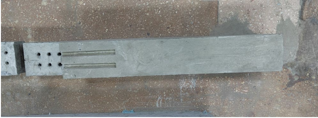
Рис. 4 - Внешний вид одной части составной балки Fig. 4 - External appearance of one part of a composite beam Image by the author of the article
