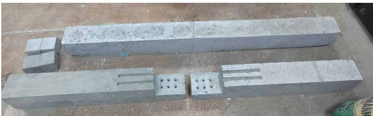
Рис. 3 - Внешний вид монолитной и составной балки
