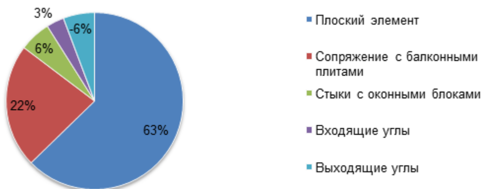
Рисунок 11. Структура удельных потерь теплоты через конструкцию 3
