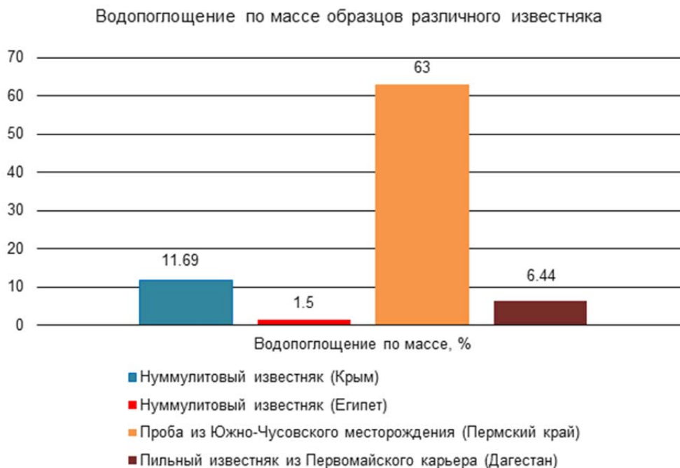
Рис. 1. График водопоглощения по массе образцов различного известняка
