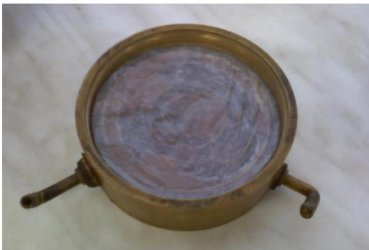
Рис. 4. Пластина одометра, перетянута полиэтиленовой пленкой.
